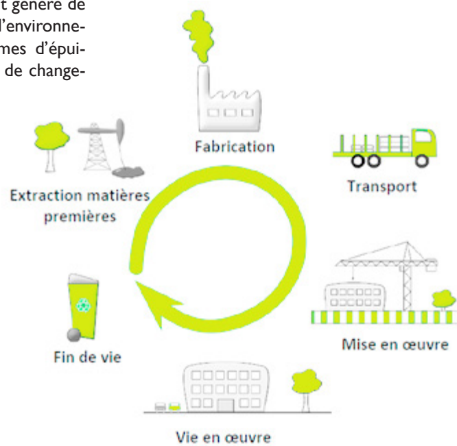
Analyse du cycle de vie d'un bâtiment
